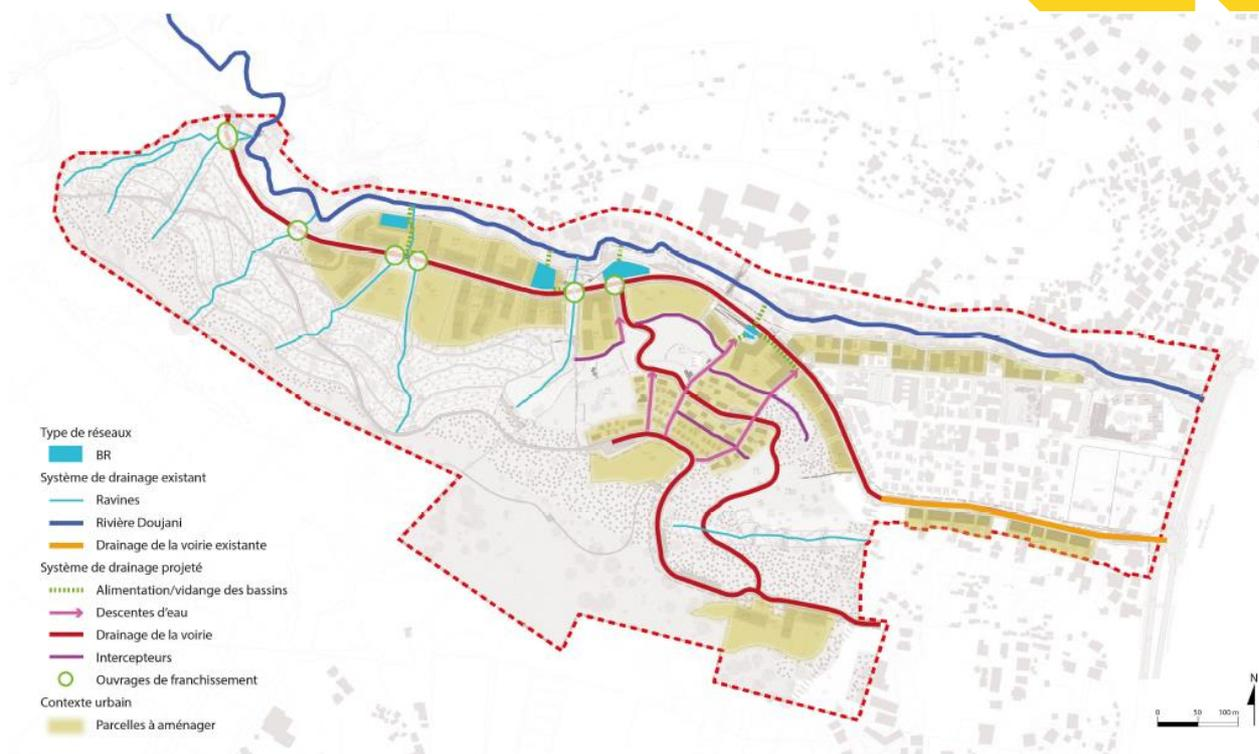
Figure 13 : Schéma de gestion hydraulique
