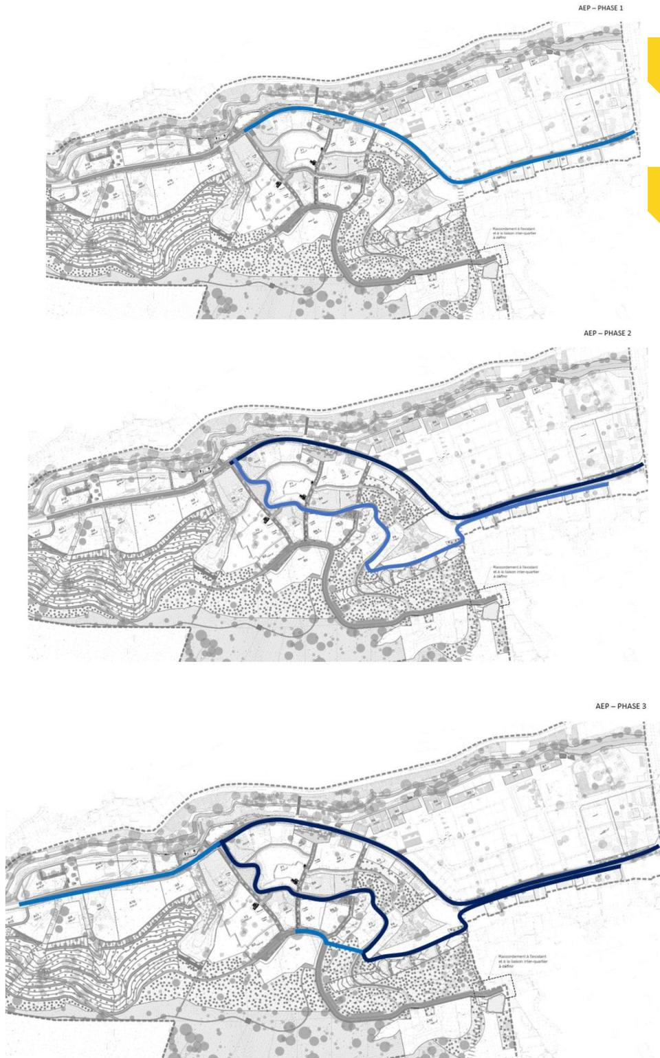
Figure 39 : Evolution progressive de l'architecture du réseau AEP
